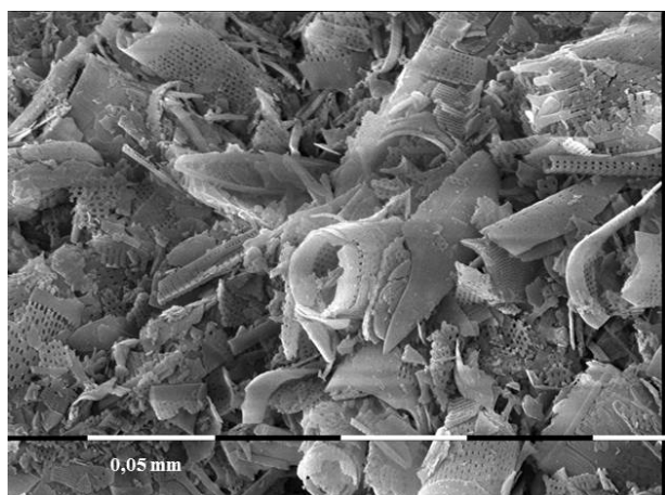
Fig. 6. SEM of the diatomite
