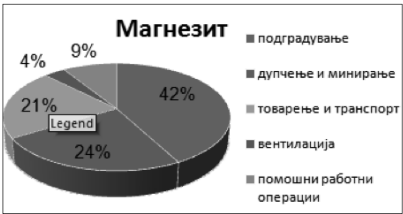
Слика 3 - Трошоци за изработка на хоризонтална рударска просторија во работна средина магnezит
