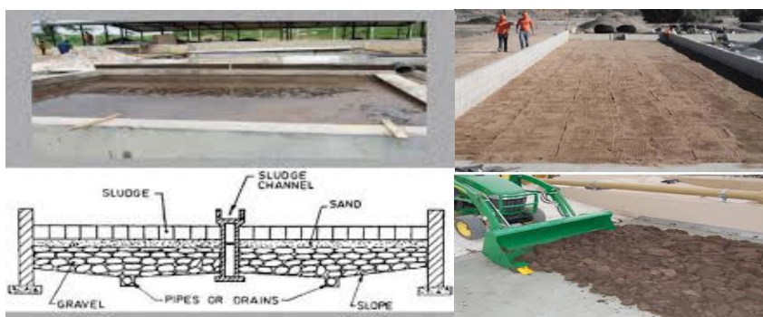
Слика 9. Технологија на легла (депонии) за сушење тиња Figure 9. Sludge drying beds technology
