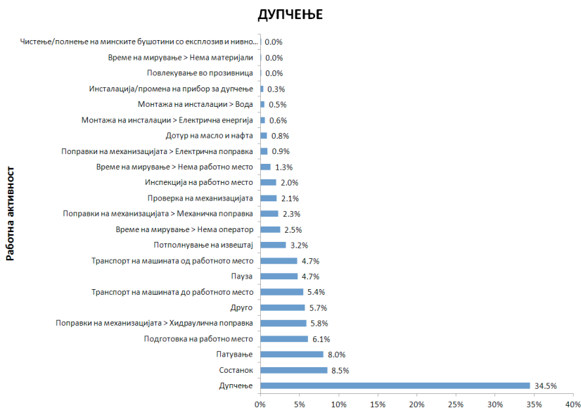
Слика 4. Процентуално учество на секоја работна активност во категорија дупчење за целиот период на истражување Figure 4. Percentage composition of each work activity in the drilling category for the entire period of study
