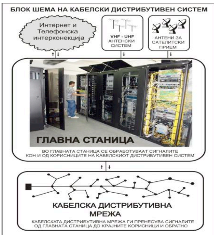
Слика 1. Блок шема на кабелски дистрибутивен систем Figure 1. Block diagram of Cable distribution system
