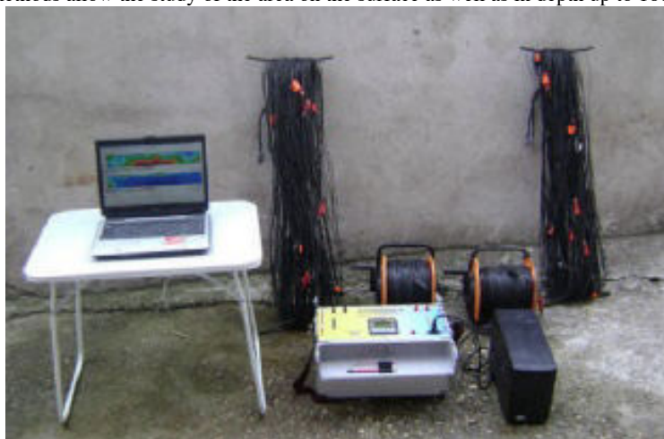
Figure 4.: Electrical tomography equipment (Electrogeotest M2) Слика 4.: Електротомографска опрема (Electrogeotest M2)
