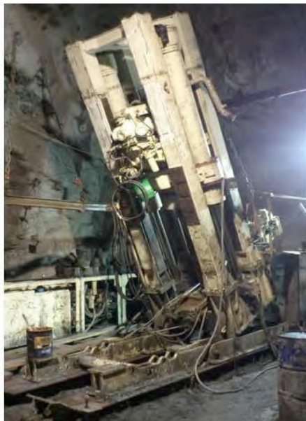
Слика 7. Општ изглед на машината за ускопно пробивање од тип HG 160 – 2
