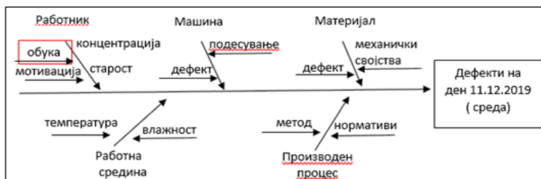
Слика 2: Ишикава дијаграм за наоѓање на причина за појава на дефекти за месец декември Figure 2: Ishikawa diagram for finding the cause of defects noted in December
