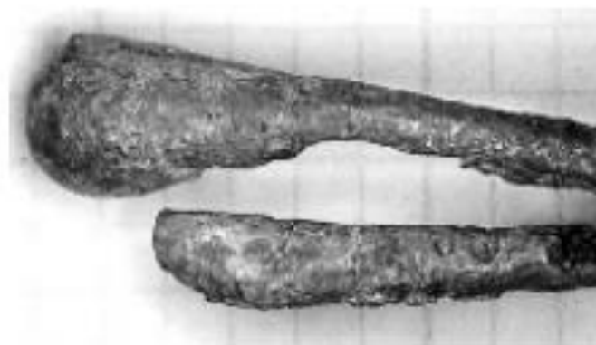
Слика 3. Топчиња настанати поради топење од пожар
