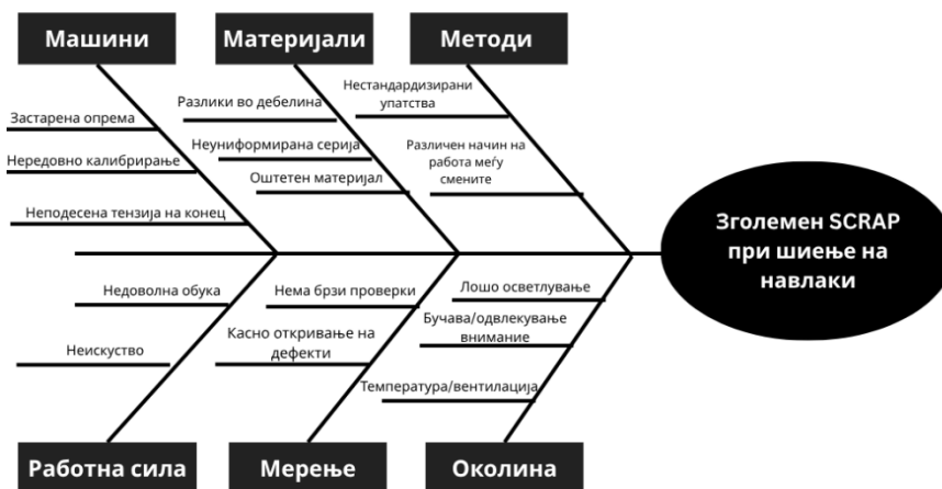
Слика 3: Ishikawa дијаграм (Рибина коска) кој ја прикажува анализа на причините за зголемен scrap при шиене на навлаки во Адидент
